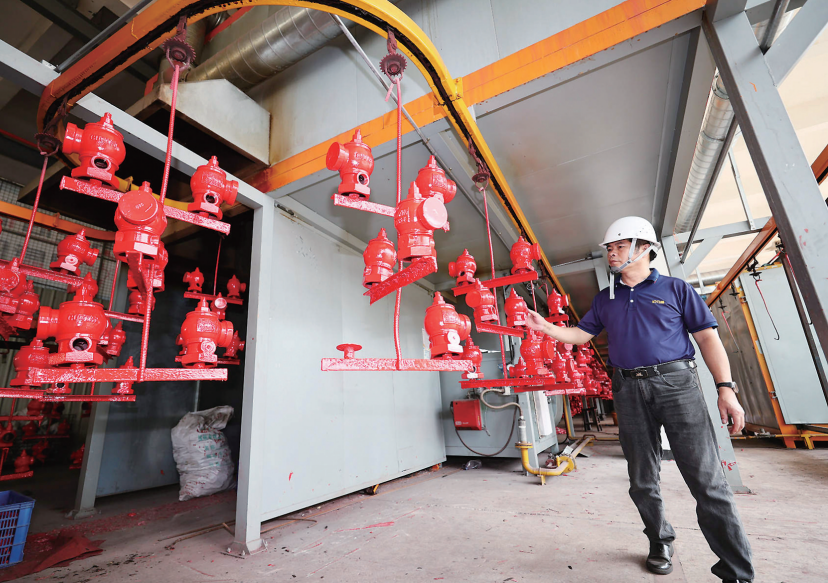
力盾实业生产车间，工人正在巡检自动喷涂生产线。
