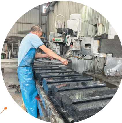
工人正在打磨水景石材。
