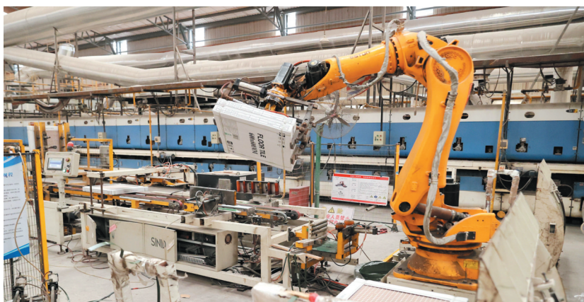
机械臂在生产线上高效完成瓷砖打包工作。
