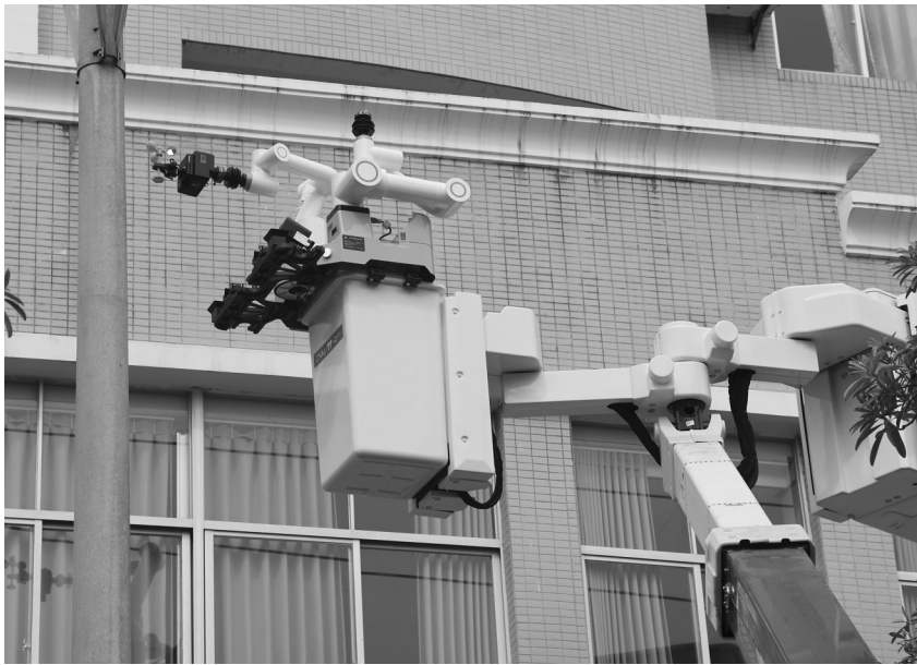
带电作业机器人正在自主完成工作任务。
