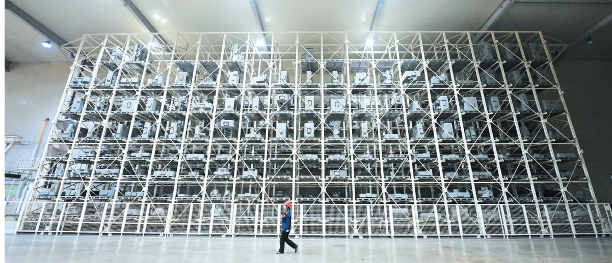
砂芯的智能化工体仓库。国家智能制造产业创新（泉州）中心，用于放置
