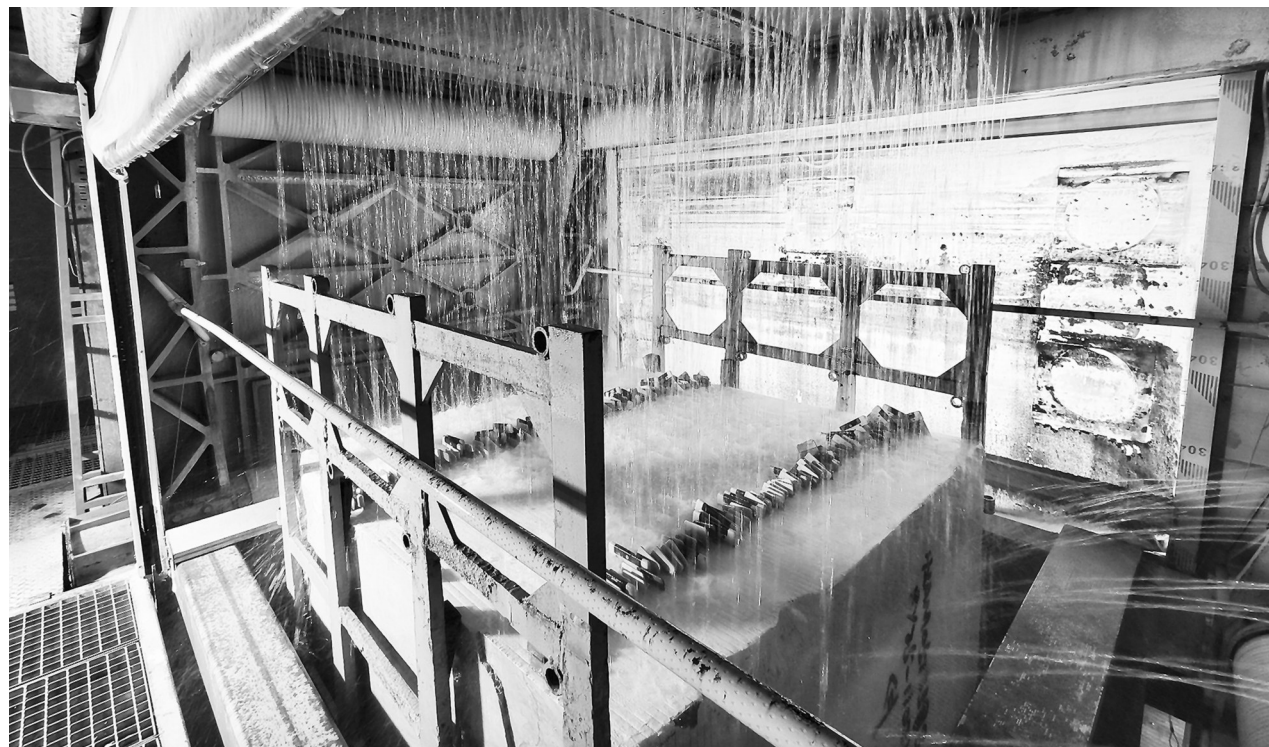
越来越多企业使用线锯切割石材。图为海丝石业有限公司大板加工中心车间，线锯正高速运转切割石材。
