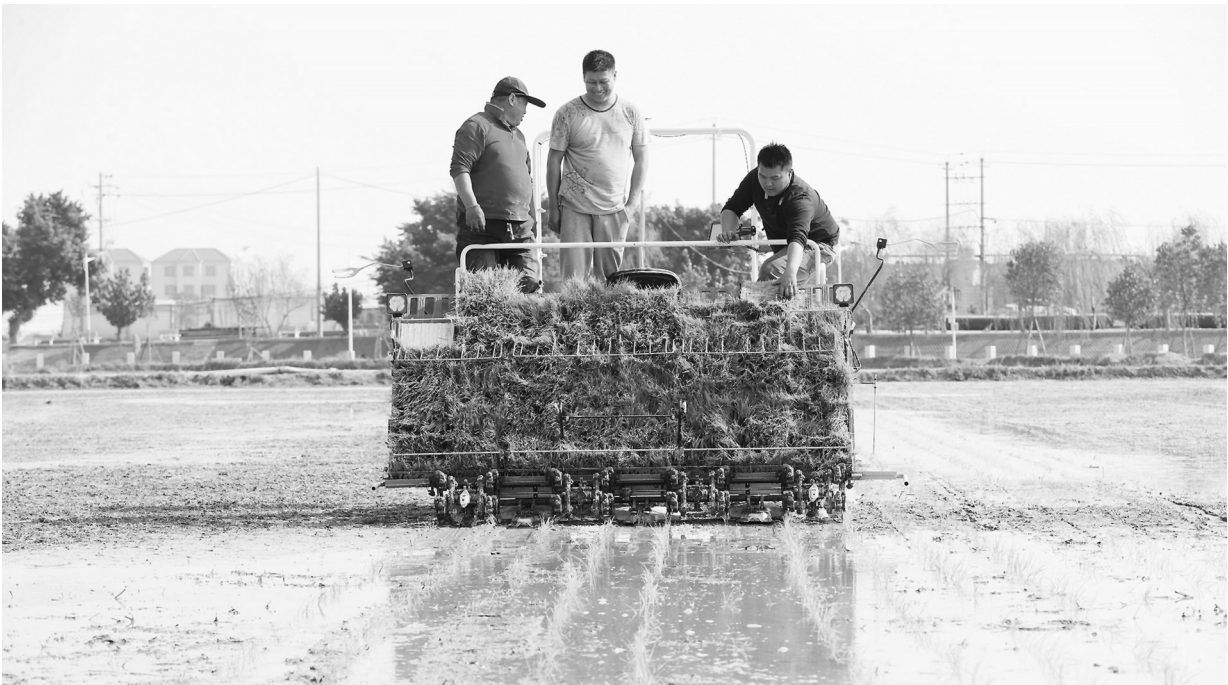
在加装北斗导航辅助直行系统的插秧机上，农户只需负责加秧和清理杂物。
