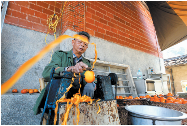
随着柿子的转动,匀称完整的柿皮,便从削皮机器里“吐”了出来。
