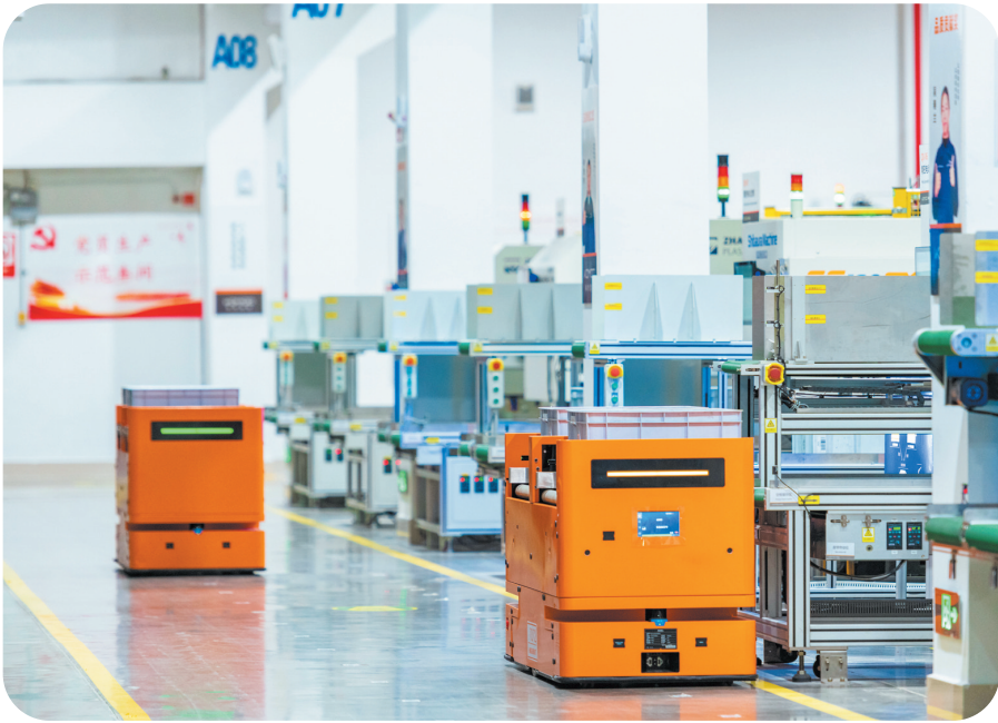
九牧5G智能马桶灯塔工厂,智能取放机器人井然有序运行在车间轨道上,完成繁杂仓储物流搬运。
