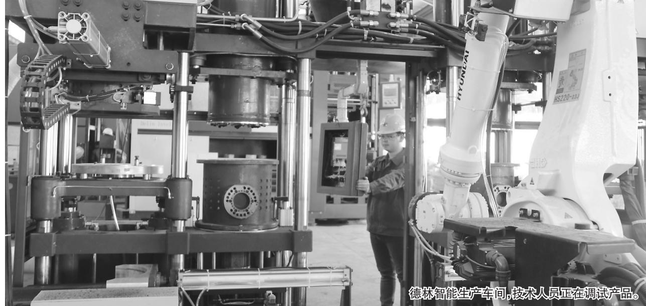
投产,需要漫长的过程。“同质化设备,同行都有在生产,但与机械手的组合,在行业内目前算是首创。模具采用落砂工艺,确保电机壳叶片的完整清晰;抽箱机构采用双节气缸设计,节约空间……”陈建团表示,一年多来,为了攻克产品研发生产过程中遇到的一系列难题,研发团队进行反复的技能论证、模拟实验、工艺的疲劳测试及自动化等方面的应用。
