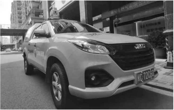
燃气激光巡检车的车顶装有专业的检测仪器。
