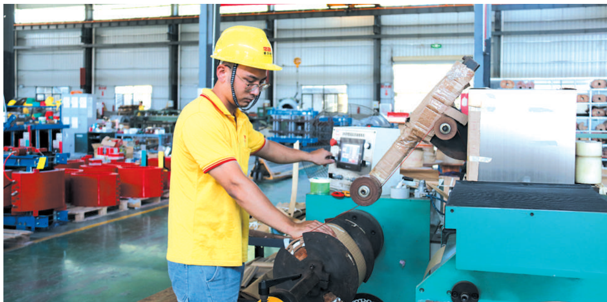
蓉中电气车间内,工人正在操作自动绕线机。
