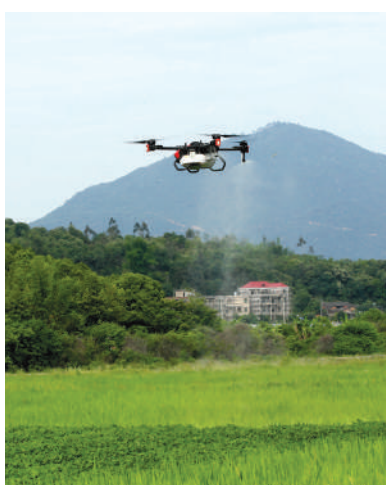
无人机均匀地将有机肥喷洒在稻苗上。
