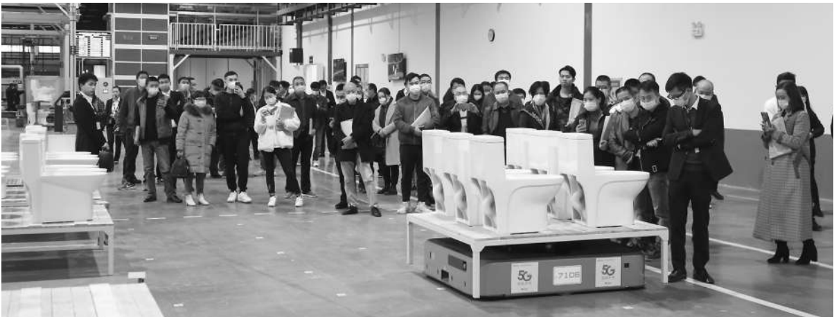
成产品的运输、入库。 AGV小车自动识别路线,准确灵活地完成
