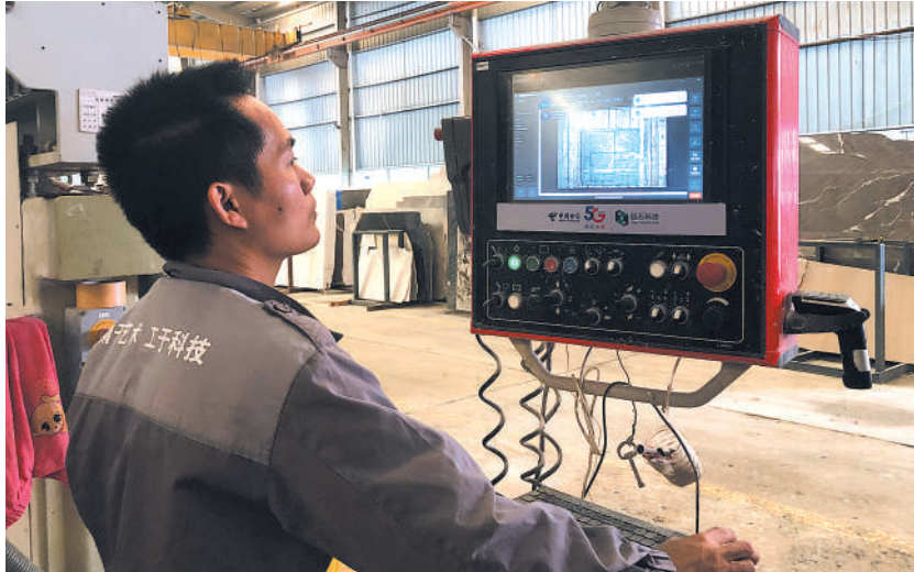
工作人员运用智能桥切机生产大板。
