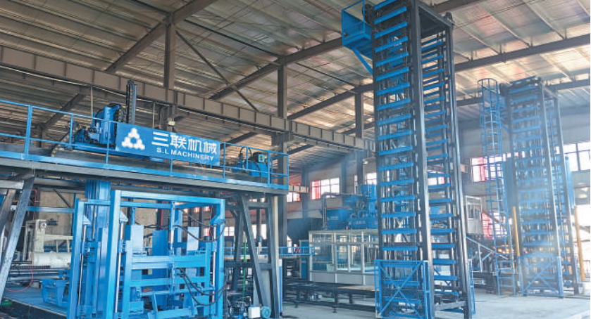
三联机械装配式轻质墙板全自动生产线。
